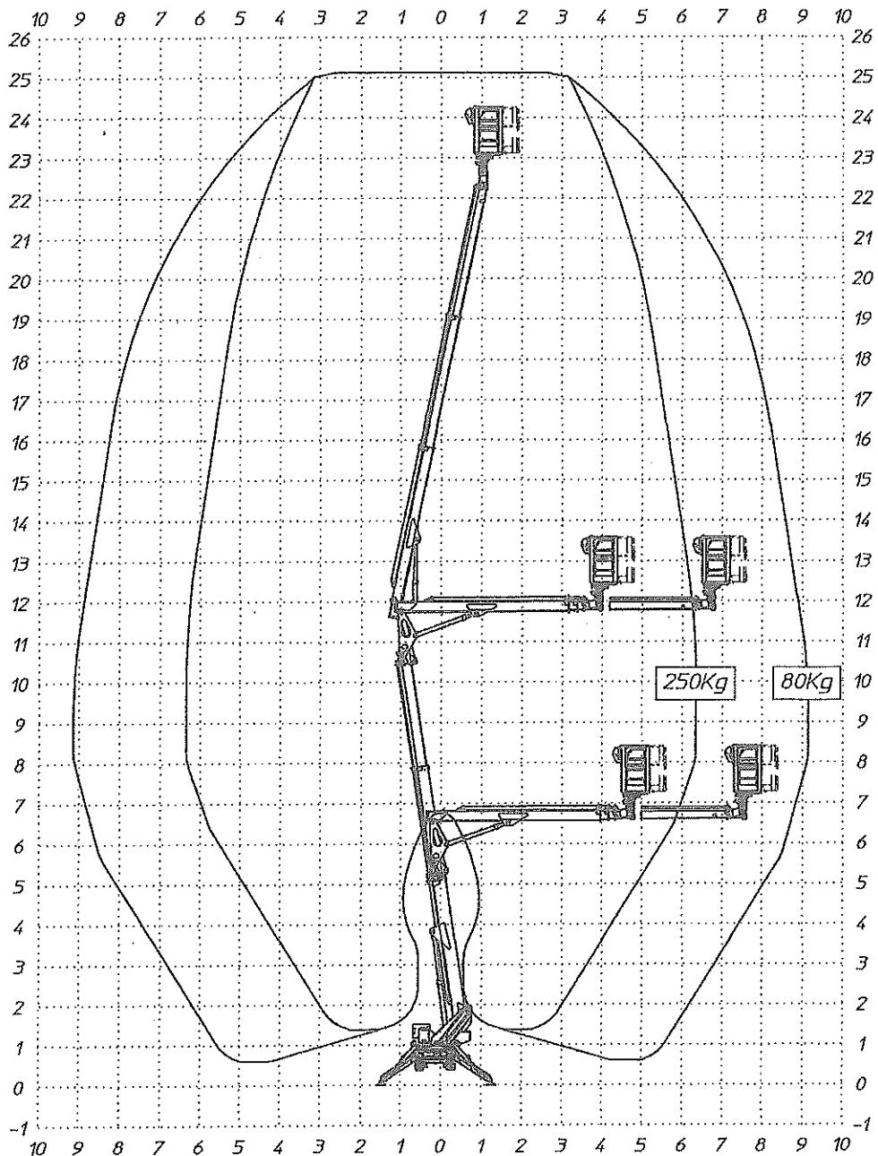
Macchina dotata di sistema di limitazione dello sbraccio a controllo di momento, le linee del grafico rappresentano le condizioni limite, ovvero con il carico massimo (carico nominale) e con il carico minimo (peso di una persona senza attrezzi - 80kg). Per ogni carico compreso fra questi due valori si ottiene una curva che sta tra le due linee tracciate.
