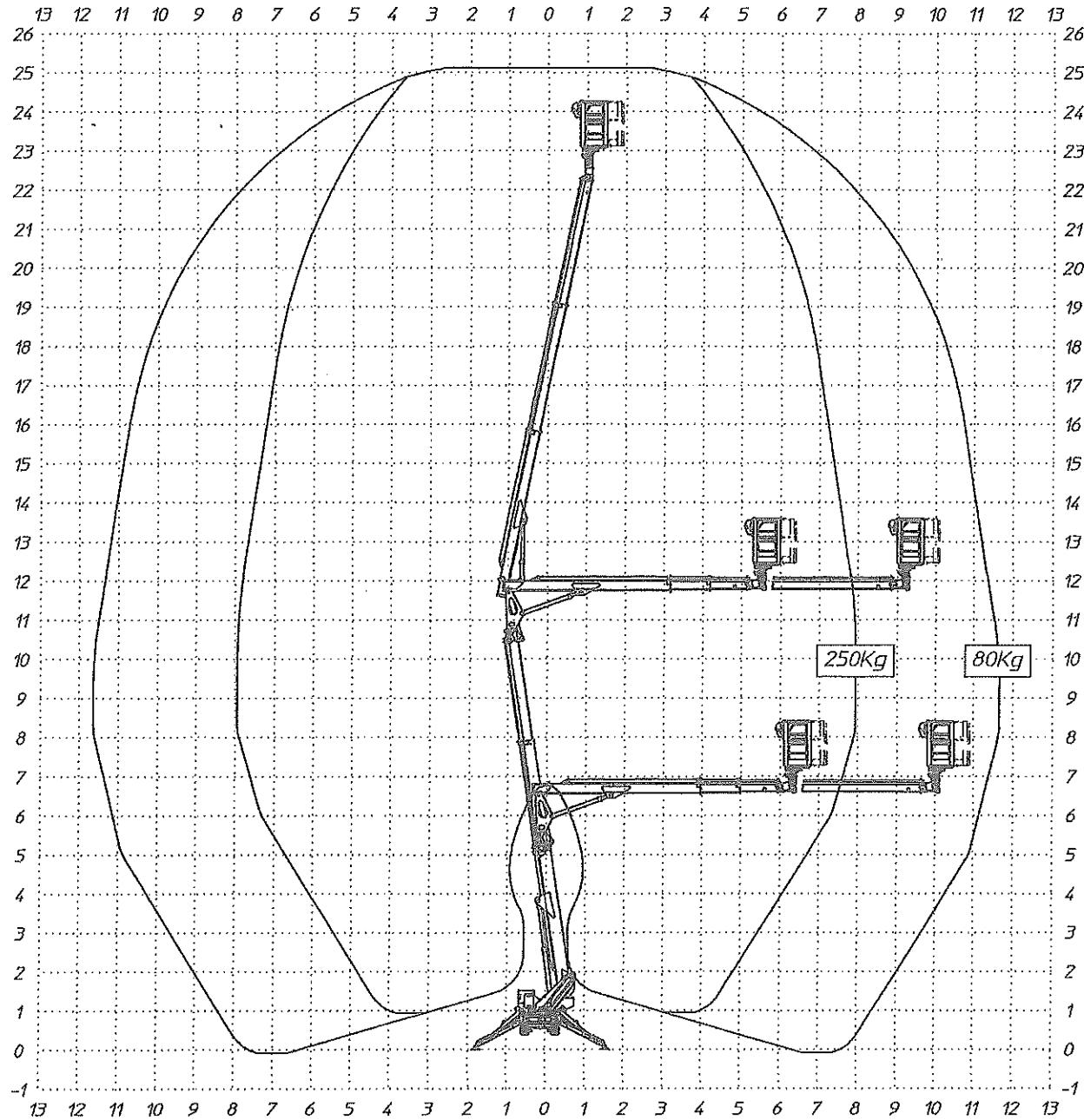
Macchina dotata di sistema di limitazione dello sbraccio a controllo di momento, le linee del grafico rappresentano le condizioni limite, ovvero con il carico massimo (carico nominale) e con il carico minimo (peso di una persona senza attrezzi - 80kg). Per ogni carico compreso tra questi due valori si ottiene una curva che sta fra le due linee tracciate.
